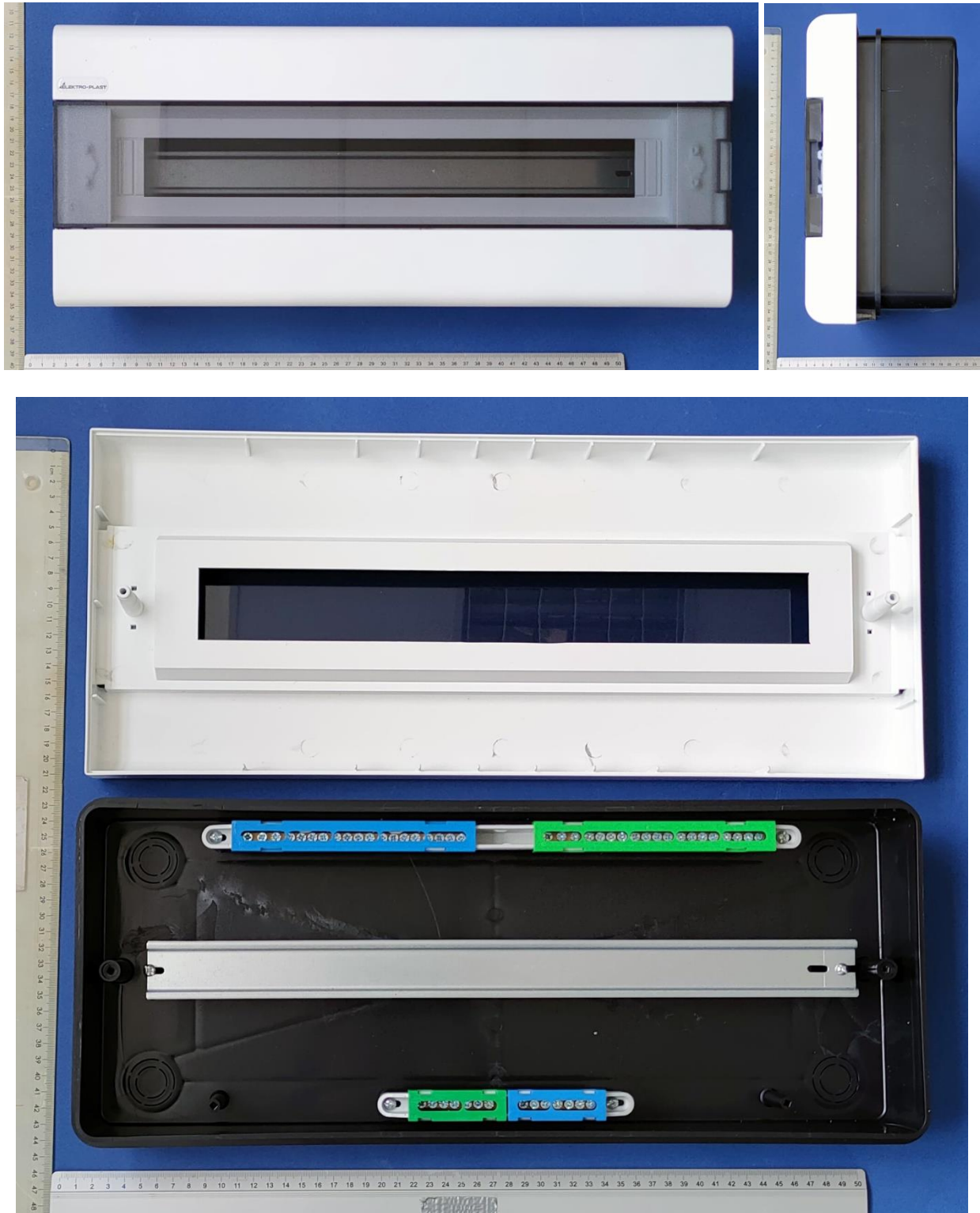
Obudowa wykonana z materiału izolacyjnego, typu SRp-24/1, oznaczona numerem 1.
